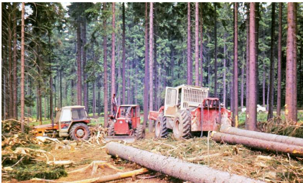
Pracoviště s protahovacím odvětvovacím strojem, vyvinutým v ČR. (Archiv autora)
