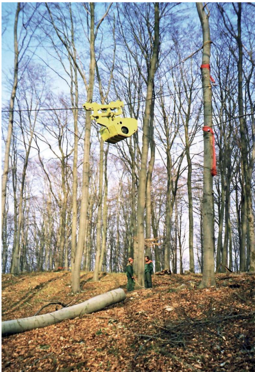
Lanové dopravní zařízení v těžbě buku. (Archiv autora)
